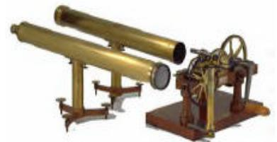
L'expérience de Fizeau se déroula donc en 1849 à *Suresnes* dans sa propre maison. Il installa une lunette permettant, par un jeu de miroirs, d'envoyer un rayon lumineux à *Montmartre* (à **8633 m** de là) où se trouvait un miroir qui permettait de renvoyer la lumière à Suresnes.
