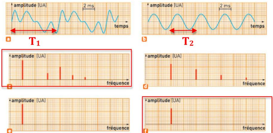
1) Pour le son **a**, on voit qu'une période correspond à 4 cm (8 petits carreaux). Comme 1cm correspond à 2ms:  $T_a = 4 \times 2 \times 10^{-3} = 8 \times 10^{-3} \text{ s}$ . Calcul de la fréquence:  $f_a = \frac{1}{T_a} = \frac{1}{8 \times 10^{-3}} = 125 \text{ Hz}$
