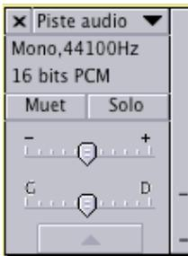
Dans AUDACITY, supprimez les pistes de l'expérience précédente, puis créez une nouvelle piste audio « mono » puis générez une sinusoïde à 1000 Hz. La fréquence d'échantillonnage est par défaut : 44 100 Hz.
