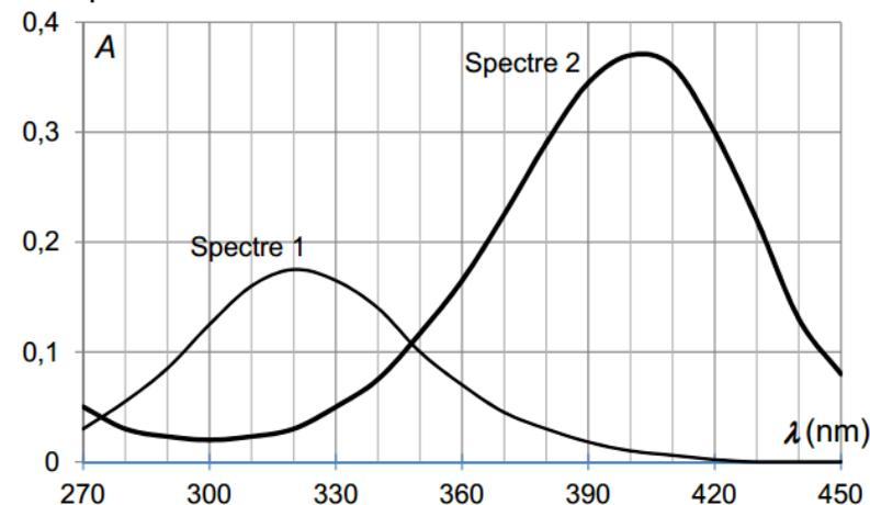
**Spectre 1** : solution aqueuse de paranitrophénol de concentration molaire  $2,0 \times 10^{-5} \text{ mol.L}^{-1}$  en milieu acide ( $\text{pH} = 5$ ).
