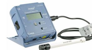
Régler le conductimètre afin qu'il affiche la bonne valeur de  $\sigma$  qui apparaît dans le tableau ci-dessus. A la fin de l'étalonnage, trempez la sonde dans le verre à pied contenant de l'eau du robinet puis séchez la avec du papier absorbant.
