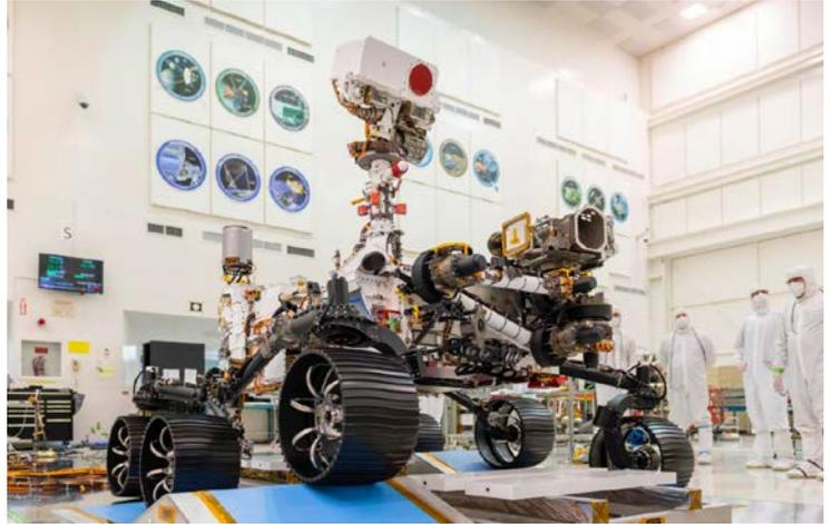
Plusieurs matériaux composent le rover. Parmi eux se trouvent l'aluminium et l'aérogel, un matériau semblable à un gel considéré comme un solide et dont la capacité à isoler thermiquement est remarquable.
