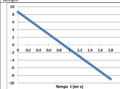
$$\text{Equation : } v_y(t) = -g \cdot t + v_0 \sin \alpha$$
